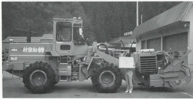
(11トン級・車輪式・ロータリー除雪装置付) スライドアングリングプラ付・WA200型
